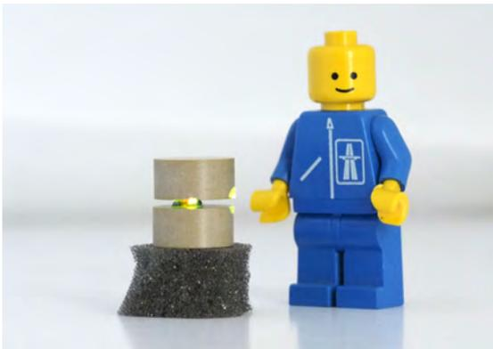
*Mit Cavity-QED-Verfahren können NV-Zentren direkt elektrisch ausgelesen werden, d.h., das Spin-Signal wird direkt in eine Spannung verwandelt. Ensembles von NV-Zentren lassen sich an Mikrowellenresonatoren hoher Güte koppeln (graue Scheibe im Bild), die sich wiederum an Mikrowellenschaltkreise anschließen lassen.*
