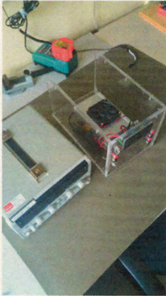
Abb. A.7: Erster Aufbau des Hochspannungsteilers (innen) mit der ersten Temperatur-Isolierung durch ein Plexi-Glas Gehäuse mit 2-Punkt-Regler (schwarzes Display, eingelassen in das Plexi-Glas Gehäuse).
