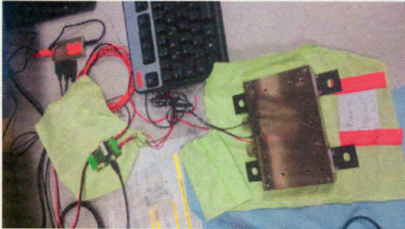
Abb. A.1: Erster Aufbau und erste Tests des PID-Controller (links im Bild) verbunden mit dem Peltier-Element (rechts).
