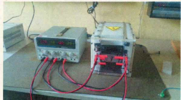
Abb. A.10: Testen der Temperatur-Stabilisierung des Hochspannungsteilers.
